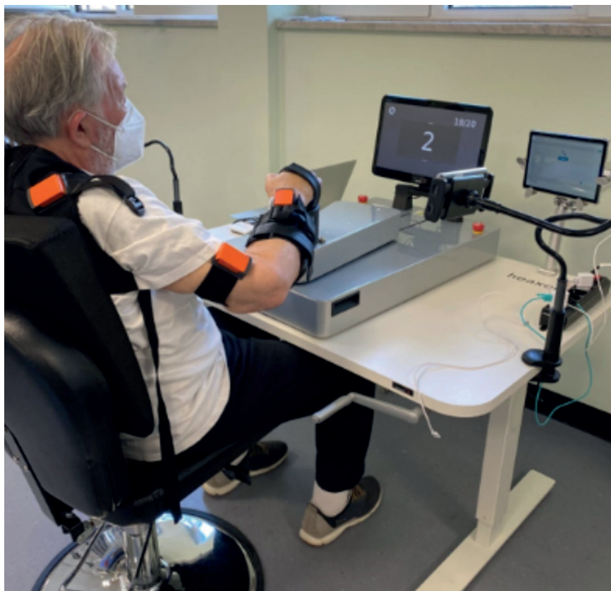
Figura 2 Paziente con sensori per la valutazione della cinematica articolare, della risposta galvanica della pelle e del segnale ECG
